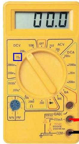
Para medir pin de carga : con el cargador conectado medir 5 volt
